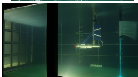
De gauche à droite et de haut en bas, essais à l'échelle 1/20 : d'une hydrolienne flottante en présence de houle, de mesure LDV en amont d'une hydrolienne carénée, d'une hydrolienne soumise à la turbulence de grille, d'une maquette à axe vertical non carénée en mouvement imposés
