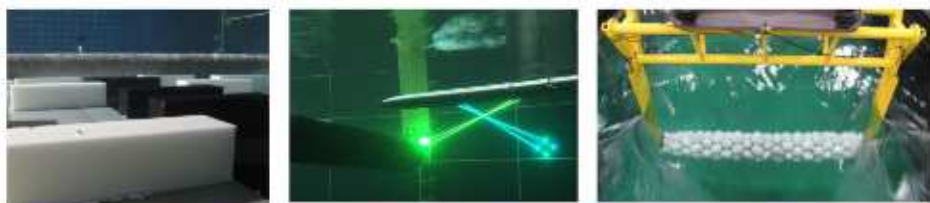
Modélisation d'une portion de câble sur un fond rugueux (à gauche), en pleine eau et colonisée par des moules (au centre) et par des coraux (à droite). L'hexapode permet d'imposer des mouvements aux maquettes. Illustration de la caractérisation du siège par mesures LDV au centre.
