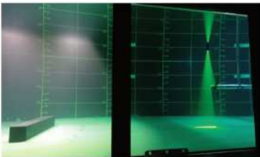
Mesure PIV en amont du rotor de l'hydrolienne à axe horizontal
