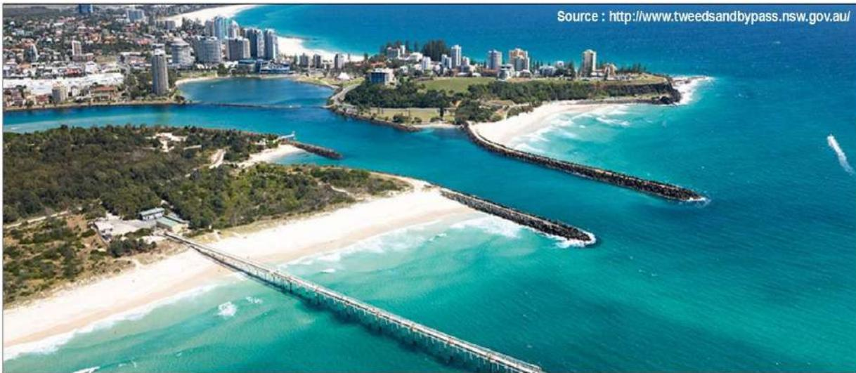
Illustration 102 : Débouché en mer de la Tweed River avec la structure de dragage des sédiments sur l'avant-plage (ponton au premier plan)
