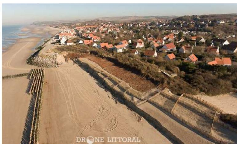
Illustration 82 : Aménagement d'urgence de la dune d'Aval, Wissant (62), rechargement, brise-vent, plantation et pieux hydrauliques : situation en août 2016, présentée sur la photo du haut (Source : Les amis de la baie de Wissant) et situation en janvier 2017, présentée sur la photo du bas avec une orientation de la prise de vue inversée Sud-Nord (Source : Drone Littoral)
