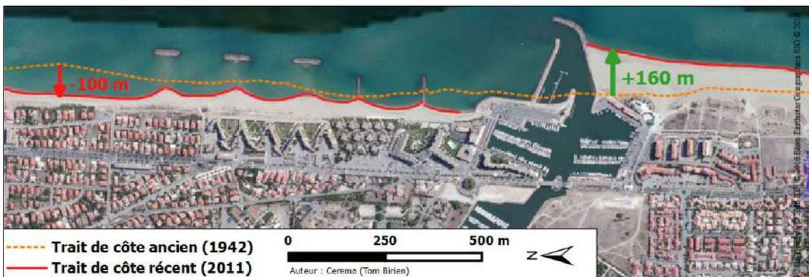
Illustration 36 : Plages du Lido, des Miramars en érosion au nord et port du Barcarès qui bloque le transit littoral avec l'accumulation sédimentaire au sud
