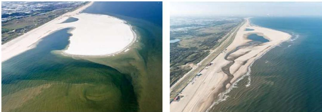
Illustration 2: Le générateur de sable « The Sand Motor » de Delfland (à gauche) juste après sa mise en place en juillet 2011 et (à droite) en évolution de forme en octobre 2013 (Source : De Vriend et al., 2015)
