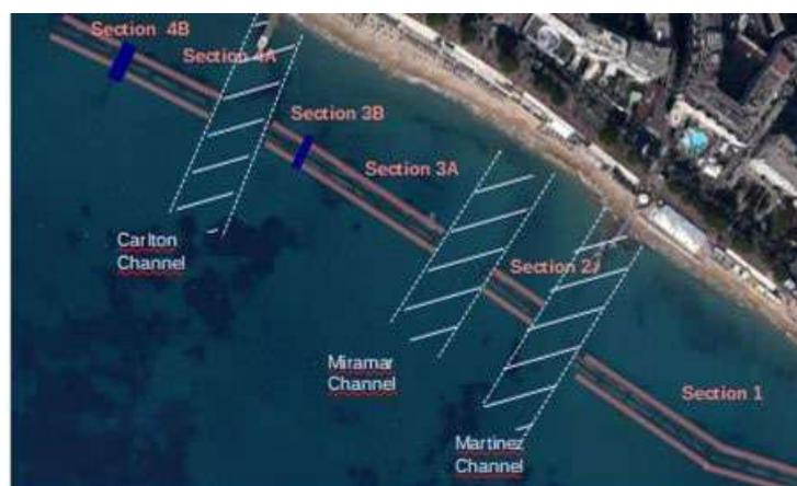
Illustration 112 : Localisation des quatre sections de géotubes de la digue sous-marine réalisée devant les plages de la Croisette (Source : TRASOMAR)
