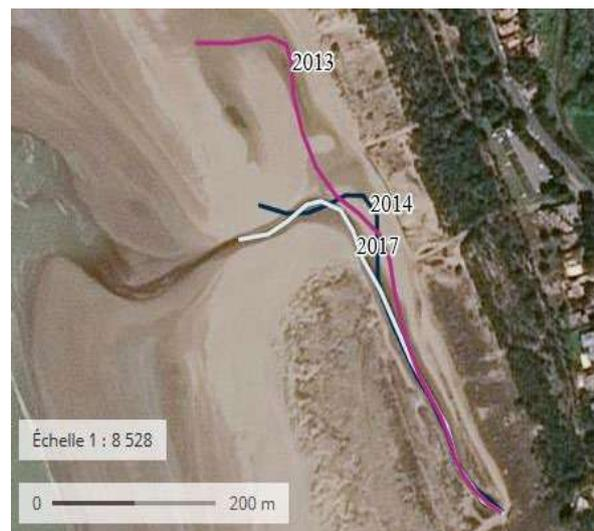
Illustration 144 : Evolution du cheminement du Boivre sur la plage de l'Ermitage à Saint-Brevin-les-Pins (44) suite à l'installation des filets S-Able en 2013 (à gauche : divagation du Boivre sur l'estran) et 2017 (à droite : redressement du trajet du Boivre au plus près de la mer) ; (Source : SAH Sud Loire)
